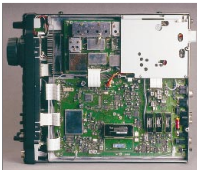
Innenansicht des IC-746, von unten gesehen. Es lassen sich drei ZF-Filter (zwei auf 9 MHz, eines auf 455 kHz), wie hier geschehen, einfach durch Stecken nachrüsten.
