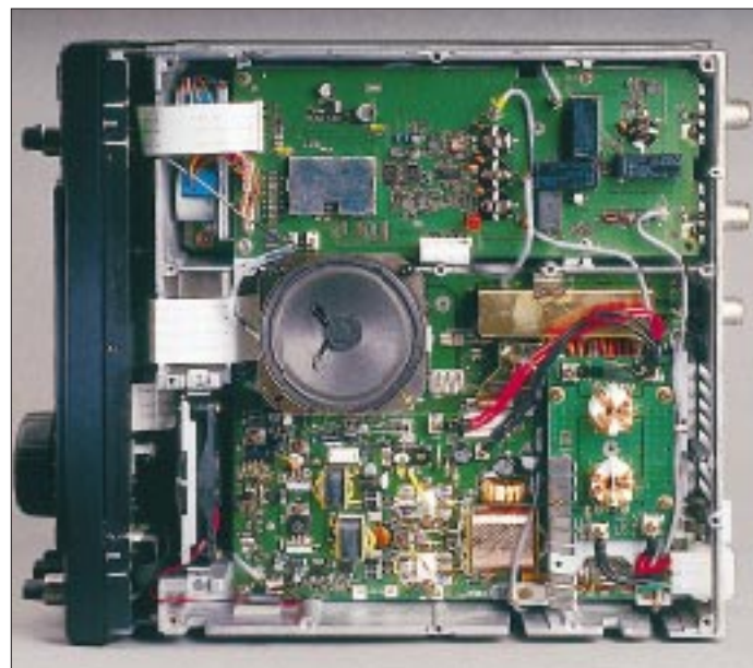
Innenansicht des IC-746, von unten gesehen. Es lassen sich drei ZF-Filter (zwei auf 9 MHz, eines auf 455 kHz), wie hier geschehen, einfach durch Stecken nachrüsten.
